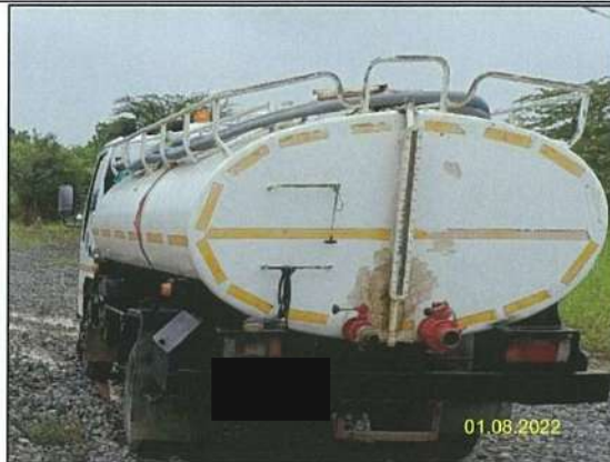
ข) รถดูด (Vacuum) สำหรับดูดโคลนโซเดียมเบนโทไนท์
